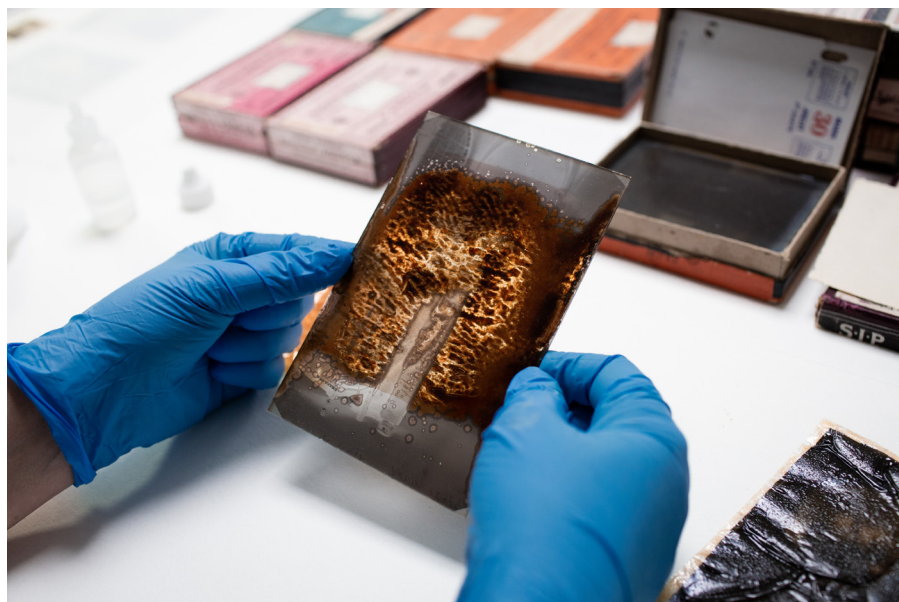
Acétates et nitrates de cellulose sont souvent présents sur les supports anciens. Ils sont hautement fragiles et particulièrement inflammables. Il faut prendre des protections particulières pour les manipuler.
